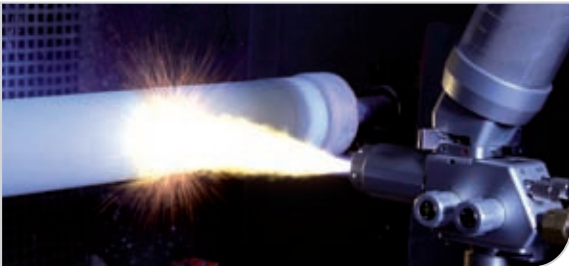
Aufspritzen auf die Werkstoffoberfläche ...
